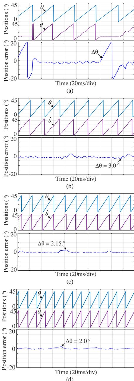
Fig. 17. Position estimation results of the conventional PLL sensorless method. (a) 200 r/min. (b) 300 r/min. (c) 400 r/min. (d) 500 r/min.
